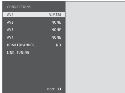
Omogočena je možnost dodajanja novih HDMI-virov. Kadar koli lahko vklopite ali izklopite priključek HDMI, priključenega v vtičnico HDMI-B.
